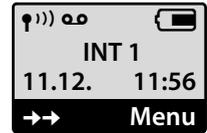
Ist der **Eco-Modus** + (→ S. 2) aktiviert, wird oben links das Symbol
